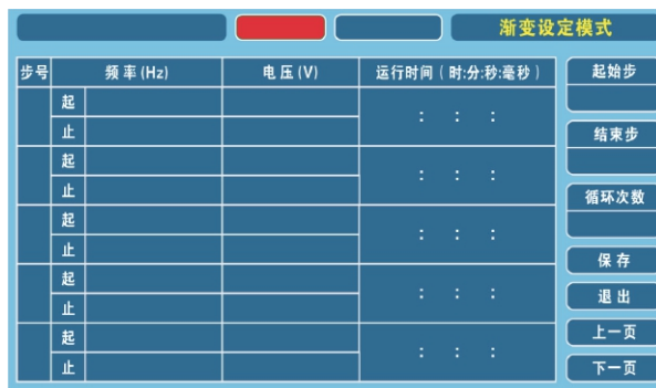
渐变设置页面可设置所需电压、频率、运行时间、初始步、结束步
